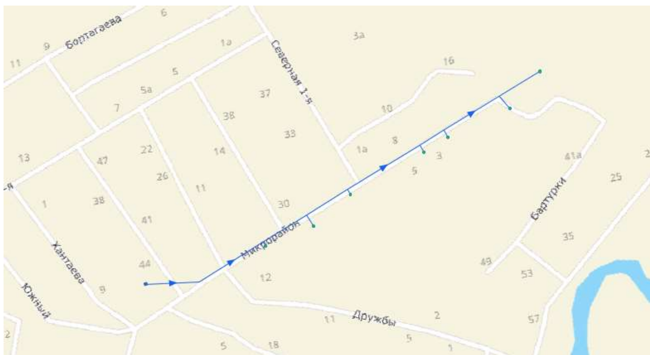
Рис. 6. Система водоснабжения от водонапорной башни по ул. Хантаева, 9а
